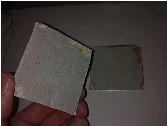
Lattiapinnasta otettu mikrobimateriaalinäyte tai ns. bulk-näyte flec-analyysia varten.
